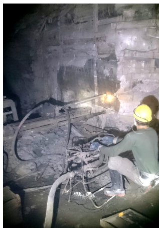
Рис. 5. Выбуривание керна из многослойного закладочного массива в выработке 38/4
