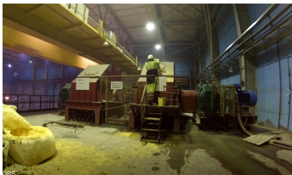
Рис. 4. Дозирование пластифицирующей добавки в люк конвейера №2 ПЗК ШС
