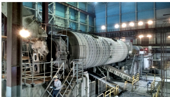
Рис. 3. «Мельничная» технология приготовления закладочных смесей на ПЗК шахты «Скалистая»
